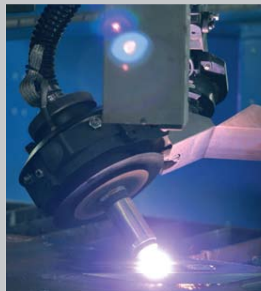
Agregat plazmowy do ukosowania Skew Axis Rotator A do automatycznego ukosowania
